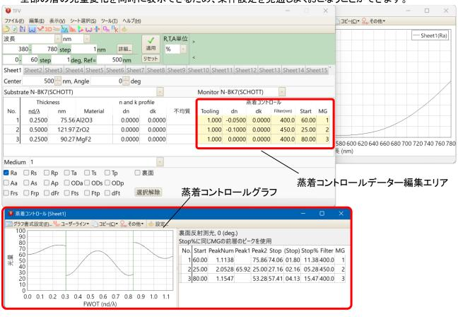
Monitor : モニターガラスの種類 **Tooling** : モニターガラスと製品基板の膜厚比(Tooling =基板上の膜厚/モニター上の膜厚) dn : 屈折率補正値(成膜中の屈折率補正) Material で設定した膜物質の屈折率に対してここで設定した値が加算される dk :吸収係数補正(成膜中の吸収係数補正) Material で設定した膜物質の吸収係数に対してここで設定した値が加算される Filter : 光学測光に使用する干渉フィルターの波長(nm) Start : 光学測光の開始光量 0を指定すると前層の最終光量が開始光量となる MG : モニターガラス使用位置 同じモニターガラスに重ねて成膜する場合は同じ番号を指定します
